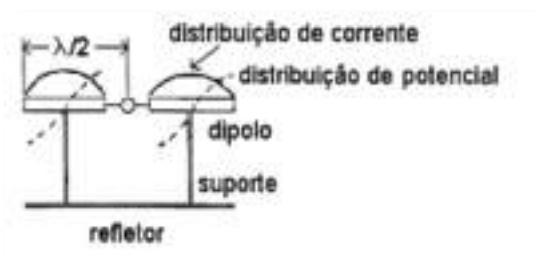
Fig. 38: Distribuição de tensão num dipolo de onda completa.
