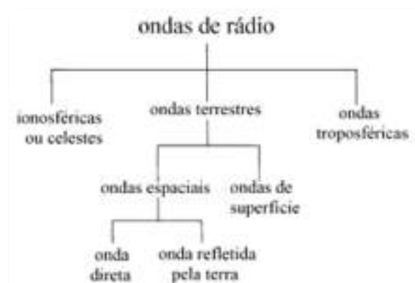
Fig. 48: Modos de propagação das ondas de rádio.
