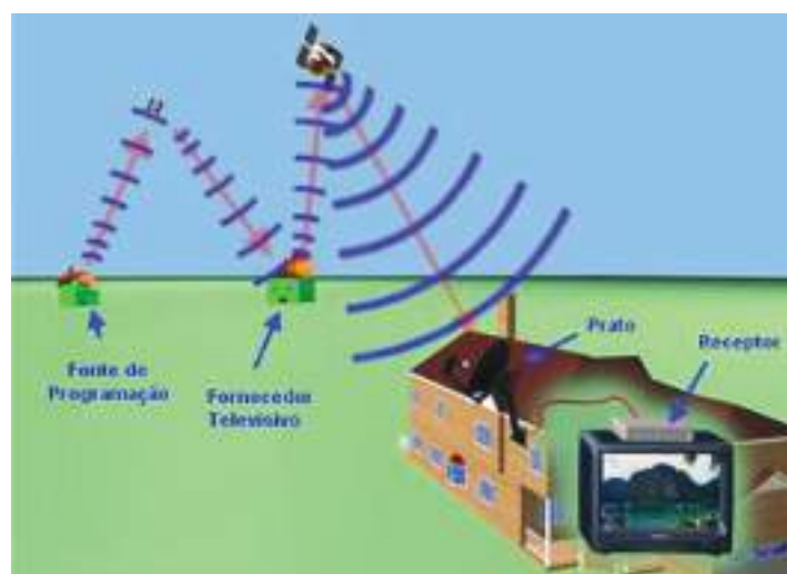
Fig. 2: Componentes de um sistema de televisão por satélite.
