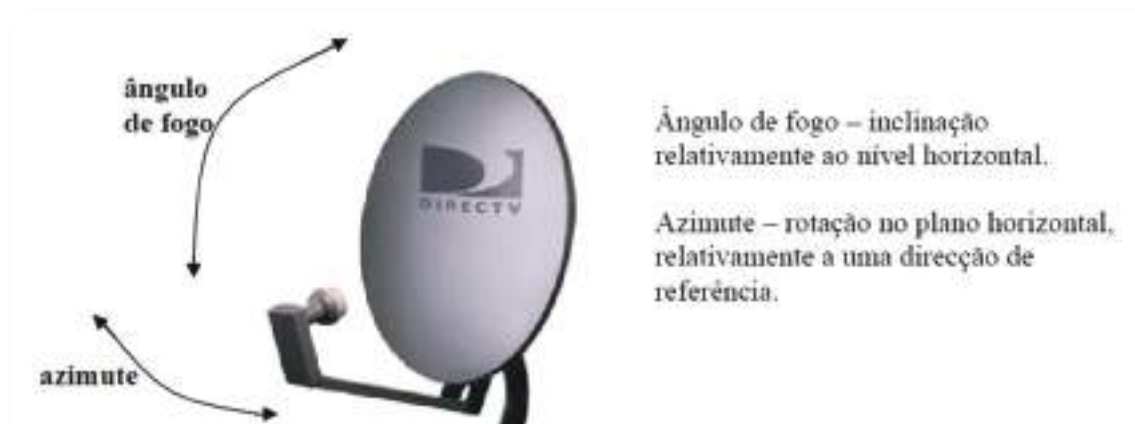
Fig. 6 – Graus de liberdade de uma antena parabólica.
